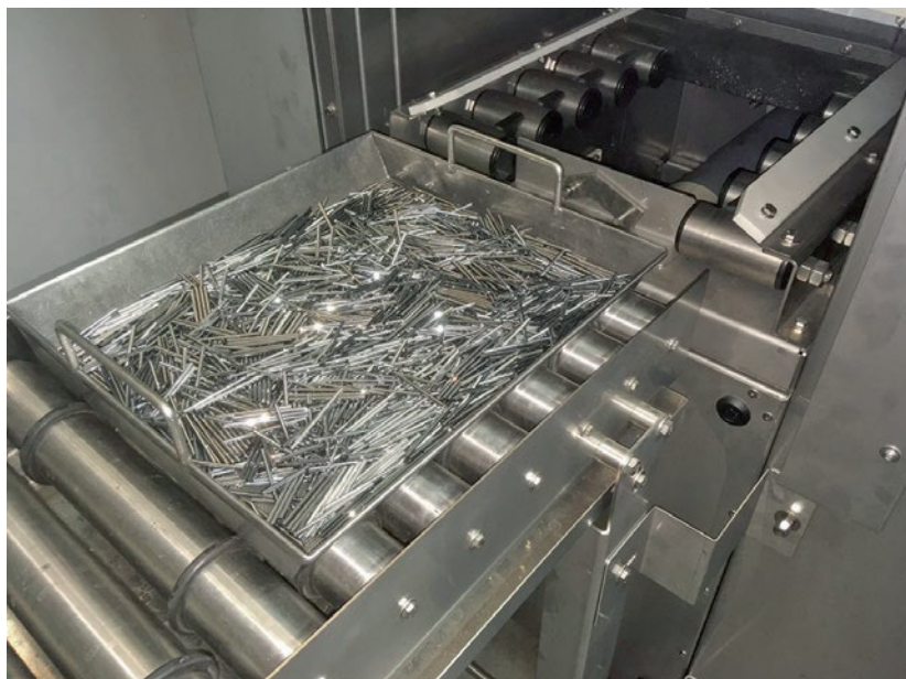
Körbe mit Hartmetallstäben beim Einfahren in den Trockner. Dort werden die Stäbe bei 45 °C in drei Minuten vollständig und fleckenfrei getrocknet.
