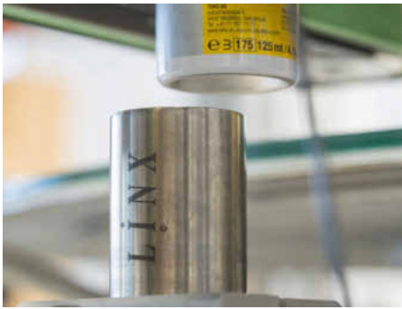
Der Linx 8920 von Bluhm Systeme kennzeichnet die Dosenböden kopfüber
