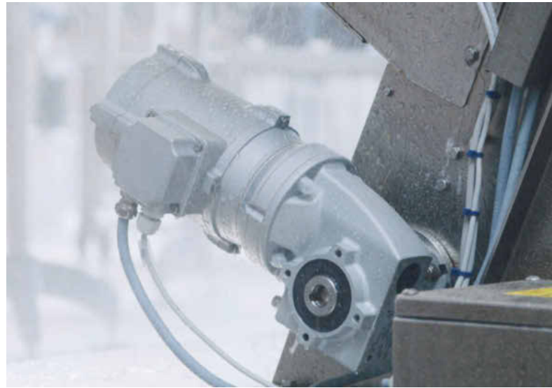
In Umgebungen mit starker Feuchtigkeit ist die Korrosionsbeständigkeit der Nord-Antriebe mit glatten Oberflächen und der NSD-TupH-Ausstattung wichtig
