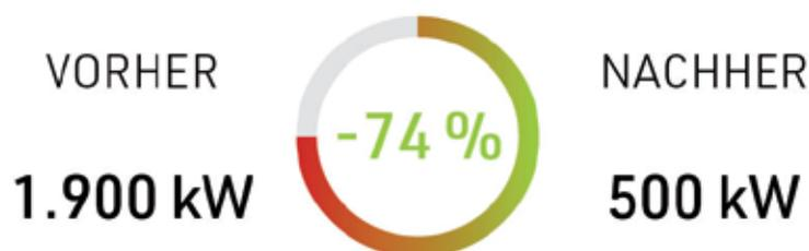
Abb. 2: Durch den Einsatz einer Wärmepumpe konnte der Energiebedarf des Trockners von ehemals 1.900 kW thermisch auf 500 kW elektrisch gesenkt werden – das entspricht einer Einsparung von 74 %. Bild: Harter GmbH
