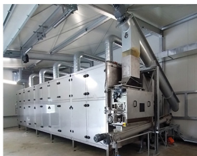
Für pastöse Schlämme gibt es kontinuierliche Ein- und Mehrband-Trockner mit Wärmepumpe
