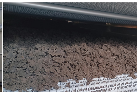
Für pastöse Schlämme gibt es kontinuierliche Ein- und Mehrband-Trockner mit Wärmepumpe
