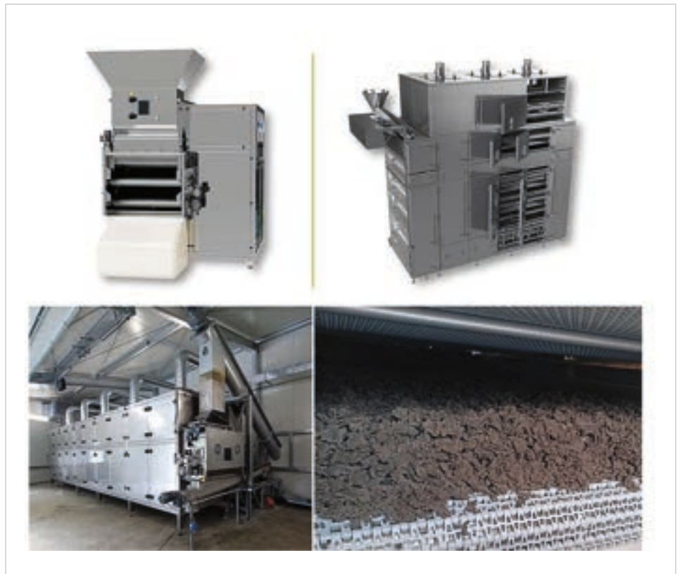
Für pastöse Schlämme stehen nun ebenfalls kontinuierliche Lösungen zur Verfügung: Ein- und Mehrbandtrockner, alle mit Wärmepumpentechnik.
