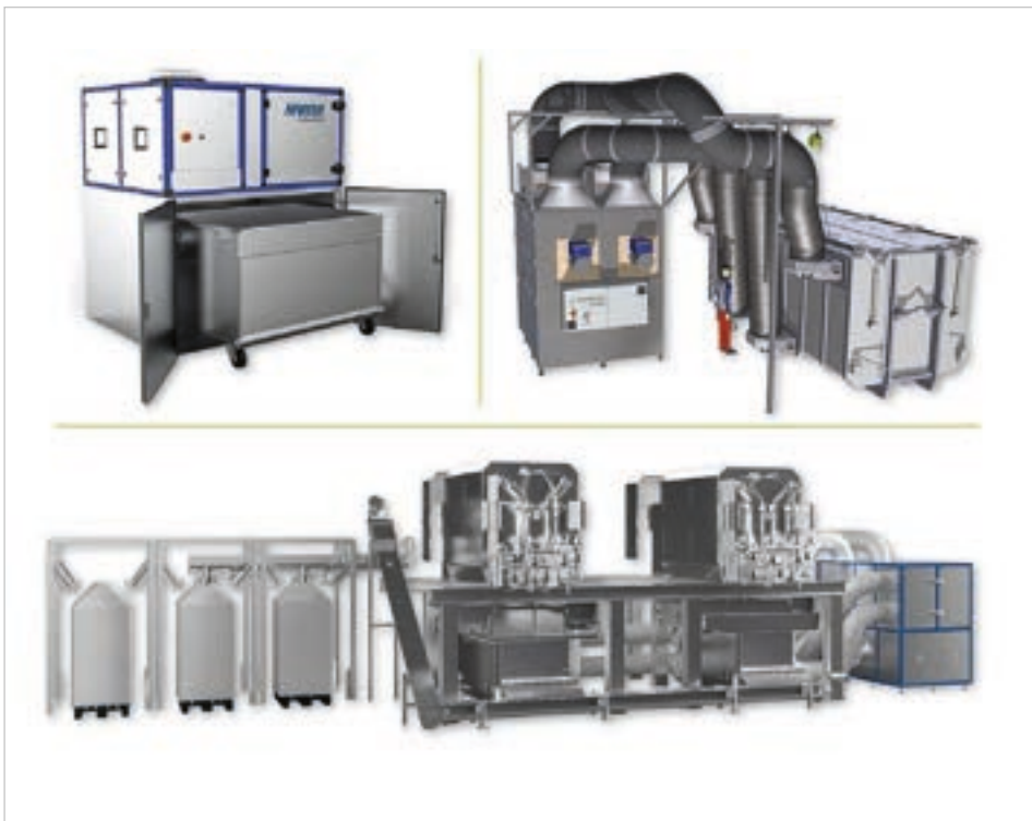
Stichfeste Schlämme werden bei etwa 50 °C in Containern auf einen Trockenstoffgehalt von 80 bis 90 Prozent reduziert. Betreiber können damit bis zu 60 Prozent ihrer Entsorgungskosten einsparen.
