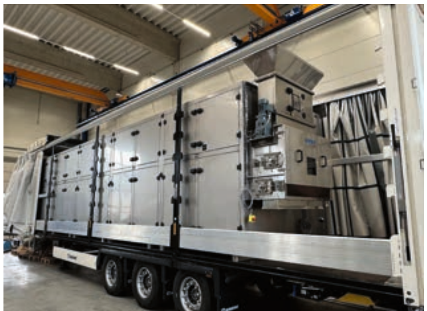
Die Bandrocknermodule können je nach Bedarf auf einem LKW oder Anhänger montiert werden, um eine flexible und effiziente Klärschlamm-trocknung zu ermöglichen.
