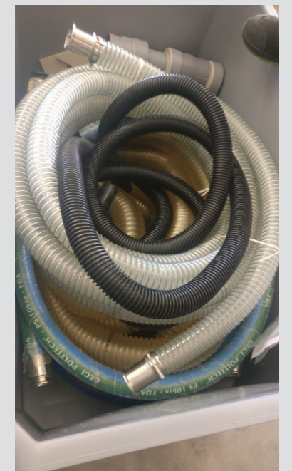
Abb. 4: Transferschläuche mit variierenden Längen und Durchmessern – die passgenaue, innenliegende Luftführung ermöglicht eine gleichmäßige, reproduzierbare und schonende Trocknung bis in den Schlauchkern.
