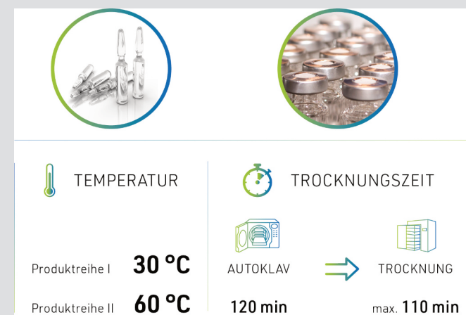
Abb. 5: Technikumsversuche geben Aufschluss über die erforderlichen Temperaturen und die Trocknungszeit und sind essenziell für die saubere Konzeption einer Trocknungsanlage.
