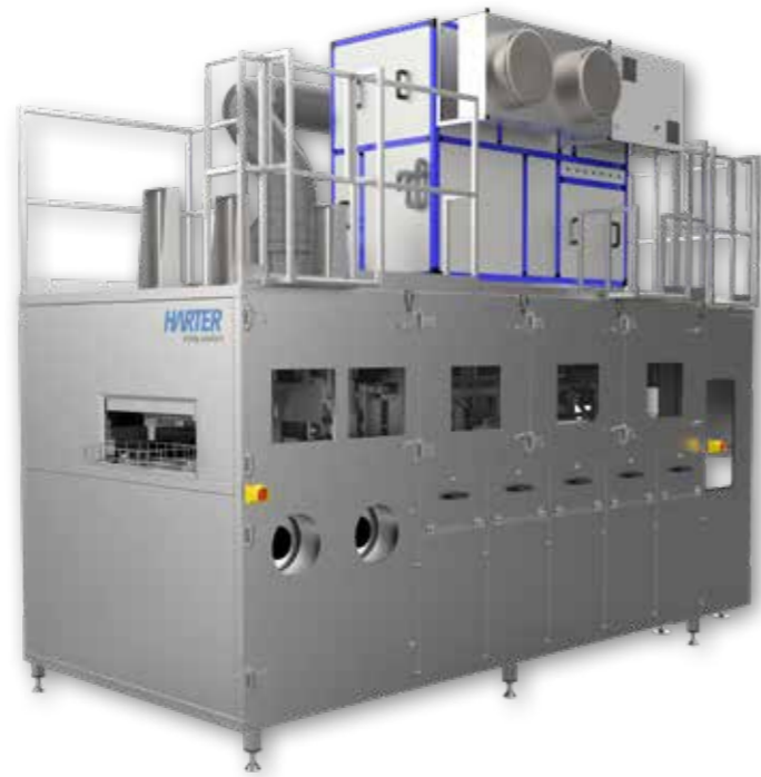
Durchlaufrockner nach Reinigungsvorgang
